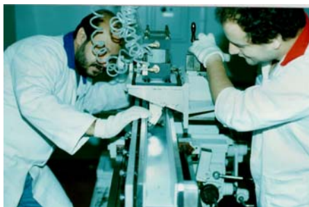
Operação de Cravamento
